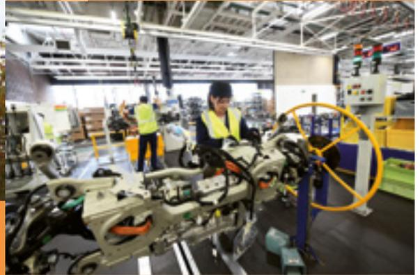
*L'usine de mécanique haut-rhinoise fournit les sites du groupe PSA en Europe pour les véhicules hybrides (fabrication des trains arrière). Un poste fortement sollicité par la transition énergétique.*
